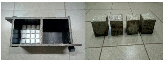
Рис. 1. Модельные образцы – кубики матрица которых равномерно заполнена дискретными пластиковыми трубками, а) – на этапе формования; б) – готовые образцы.
