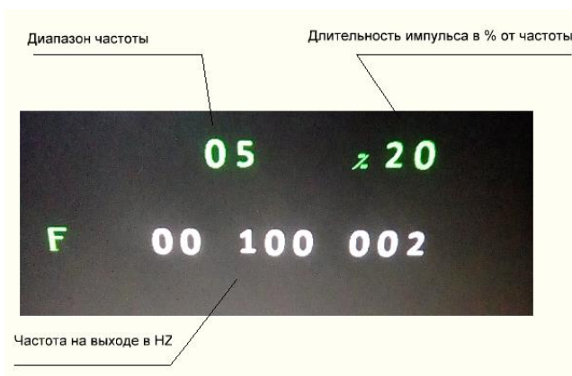
Индикация сформированного сигнала на VGA Фото выходного сигнала на экране осциллографа
